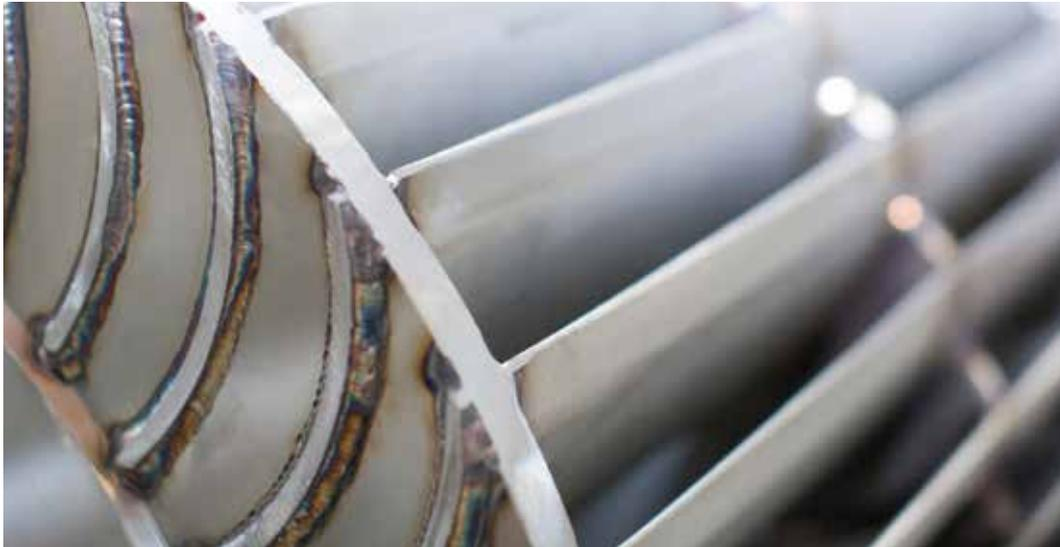
ECOWATT HYDRO TBA - TBS son turbinas Banki (o de flujo cruzado) con rueda de álabes de acero inoxidable formadas por hojas soldadas en los discos laterales.
