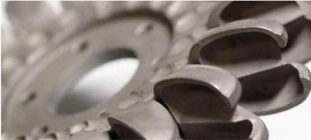
ECOWATT HYDRO TPA - TPS son turbinas Pelton de eje vertical con rueda de álabes con paletas microfundidas de acero inoxidable, fijadas en disco mediante un proceso específico de soldadura, que da una mejor calidad y una mayor duración.
